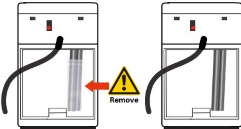
Por favor remova a proteção dos tubos dentro do depósito!
